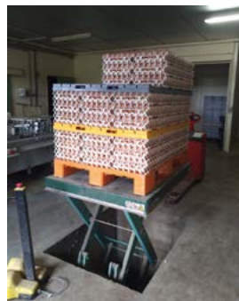
La hauteur de la table élévatrice varie en fonction du poids des alvéoles posées dessus.
